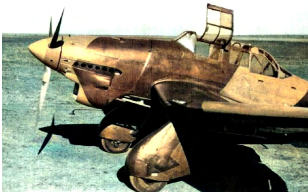
Fig. 2.- Modelo Stuka-A sin “trompeta de Jericó” instalada (VVAA, 2014).
